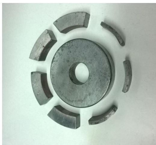
Фиг.3. Триещи двойци по схемата „ролка-сегмент” - общ изглед
