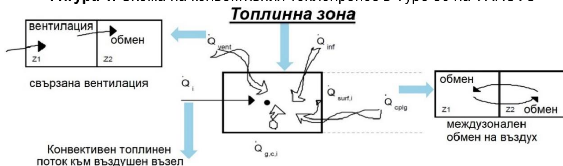
Фигура 1. Схеми на конвективния топлопренос в Type 56 на TRNSYS
