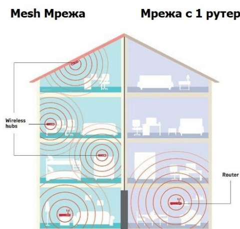
Фиг. 1. Wi-Fi MESH мрежа и Wi-Fi с единичен рутер
