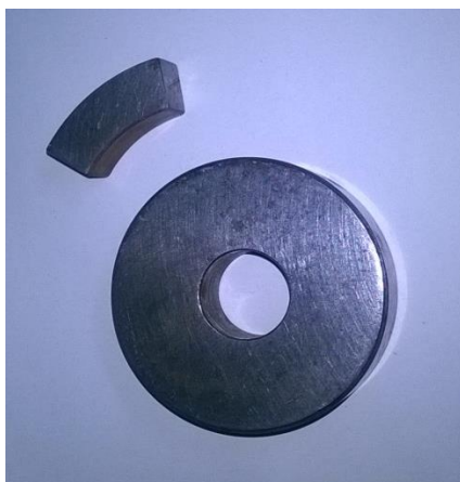
Фиг.1. Триеща двойка-ролка и сегмент с лагерна сплав на медна основа БО-30
