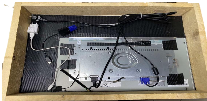
Фиг.4 Вътрешен изглед на реализираното смарт огледало
