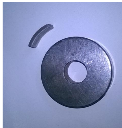
Фиг.1. Триеща двойка-ролка и сегмент с лагерна сплав на медна основа БО-30
