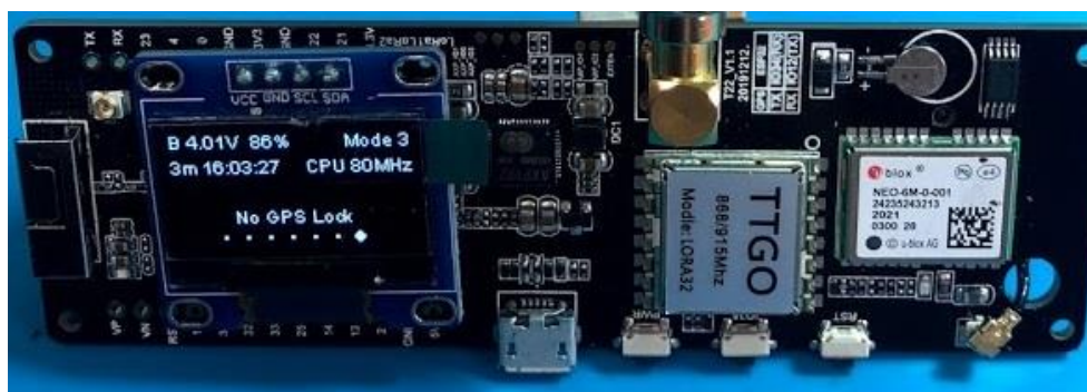
Фиг. 4 Meshtastic TTGO T-Beam устройство с вграден GPS
