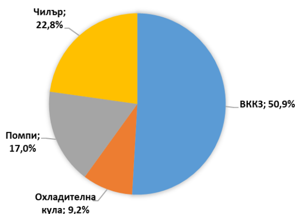
Фигура 4. Разбивка на потреблението на електроенергия на охладителната система при 100% натоварване
